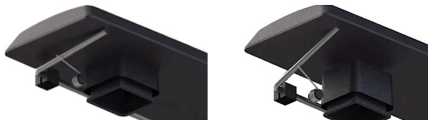
Kuva 4. Vääntöjousirakenne vähentää ääniä, sillä se pitää tasapainopalkin ja näppäinhatun tiukasti kiinni toisissaan
