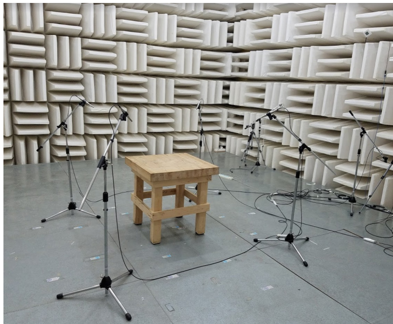
Kuva 9. Testiasetus Foxconn CMC:n kaiuttomassa kammiassa <math><6\text{ dB}</math>:n taustahälyllä
