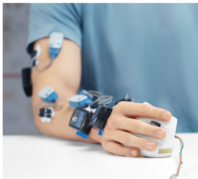
Ergonomisk testning med motion capture-sensorer på Logitech
